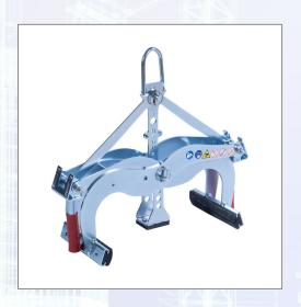
Mit dieser mechanischen Zange lassen sich parallele, ebene und nicht konische Betonelemente, wie beispielsweise Rabatten, Stellplatten, Blockstufen und Bordsteine problemlos Greifen und Versetzen. Mit Einhängeöse zur Befestigung mittels Schlupf oder Kette an z.B. einen Ladekran, Minibagger, etc. sowie einer höhenverstellbaren Auflage ausgestattet. Greifbereich: 0-400 mm, Eintauchtiefe: 165-215 mm, Backenlänge: 235 mm, Tragfähigkeit: 600 kg, Eigengewicht: 16 kg.
