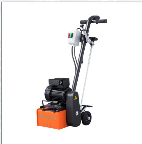
Für kleine bis mittlere Einsatzflächen zum Aufrauen von Beton, Rillieren von Betonflächen, Abfräsen von Beschichtungen und Markierungen. Einfacher seitlicher Austausch der Frästrommel. Stufenlose und millimetergenaue Einstellung der Arbeitshöhe. Mit Anschluss für Staubabsaugung. Technische Daten: - Elektromotor: 230 V/16 A/1,8 kW, - Arbeitsbreite: 215 mm, - Sauganschluss d= 51 mm, - Gewicht: 63 kg. Im Lieferumfang enthalten: komplette Frästrommel mit 84 Stück Schlaglamellen bestückt.
