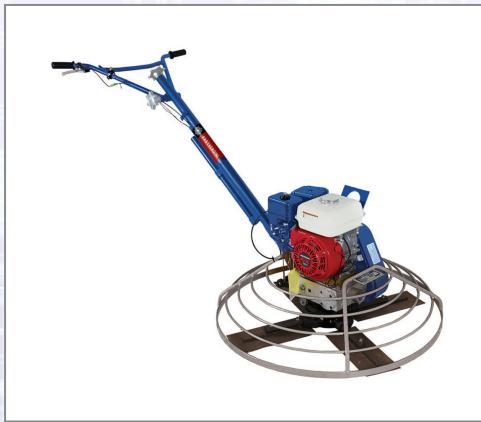
Flügelglätter LEVEL 95C mit 4 Feinbearbeitungsflügel. Zusammenlegbarer Führungsarm und Einstellung der Flügelneigung mittels mechanischen Systems. Fliehkraftkupplung, gemalten Schutzgitter, Totmannschaltung und Schnellverstellung der Führungsdeichsel. Technische Daten:
