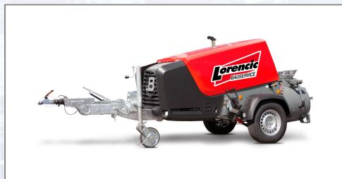
Date tehnice: - Druck-/Mischbehälter: 260 l mit Mittelabgang (200 l Nutzinhalt), - Förderentfernung: 180 m weit, 90 m hoch, - Fördermenge: 3,8-5 m<sup>3</sup>/h, - Förderdruck: 8 bar, - Kompressor: BOGE (Made in Germany) 4,4 m<sup>3</sup>/min, - Antrieb: 3-Zylinder DEUTZ Diesel mit Turboaufladung 36,4 kW (Abgasstufe STAGE V), - Tankinhalt: 70 l, - Befüllhöhe: 900 mm, - Straßenzulassung: bis 80 km/h, - Größtkorn: 16 mm, -
