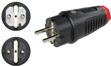
Steckermodule mit Schnapp-In Zugentlastung und Membrandichtung. Einfaches Montieren und Demontieren der Kontaktträger, großer Anschlussraum, leicht bedienbare Zugentlastungselemente (offene Schrauben). Im Steckerteil offene +/- Kontaktschrauben, ausgerichtet, Trichtereinführung der Leiter, offene Zugentlastung. Für erschwerete Bedingungen geeignet, 16 A 250 V, 3p (2P+E). Farbe: (Haube/Ring): schwarz/rot. IP 54 staub- und spritzwassergeschützt, nach österreichischer/deutscher Norm.
