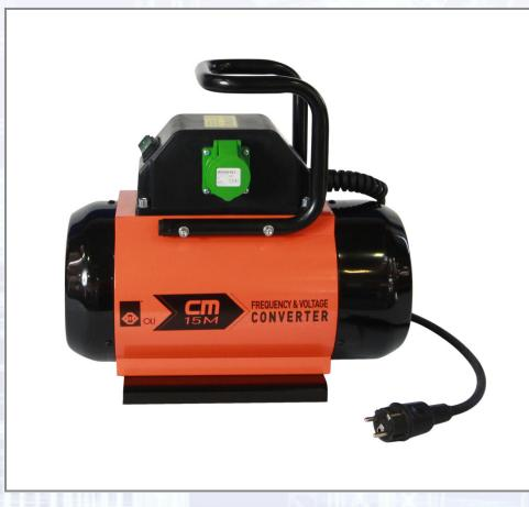
Technische Daten: - Eingang: Spannung: 230 V 1 Ph 50 Hz, Strom: 6 A, Leistung: 1,1 kW, - Ausgang: Spannung: 42 V +/- 10 %, 3 Ph, 200 Hz, Strom: 14 A, Leistung: 1,0 kVA, - Ausgänge: 1, - Tragegriff, - Versorgungskabel: 3,5 lfm mit Schuko-Stecker, - Anschlussmöglichkeiten: 1x VHN38 oder 1x VHN50 oder 1x VHN59, - Gewicht: 25 kg.
