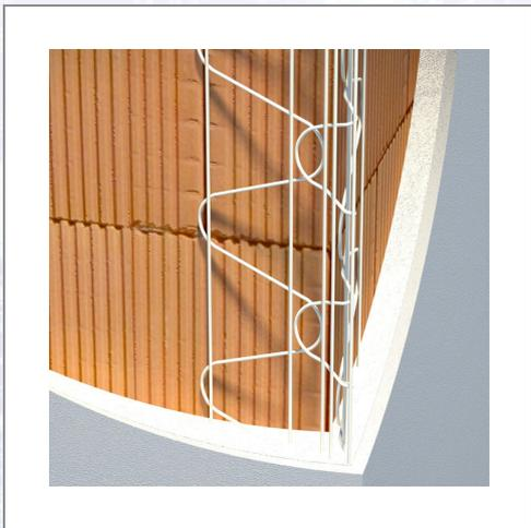
Drahtrichtwinkel für den Außenbereich mit Duplex-Beschichtung. Diese Beschichtung gewährt zusätzlichen Korrosionsschutz durch eine doppelte Beschichtung. Geeignet für synthetische und modifizierte, dünnlagige Putze. Nahezu gleiche Einsatzmöglichkeiten wie Drahtrichtwinkel aus Edelstahl.
