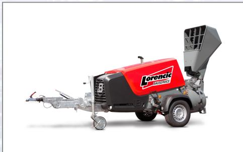
Technische Daten: - Druck-/Mischbehälter: 260 l mit Mittelabgang (200 l Nutzinhalt), - Förderentfernung: 180 m weit, 90 m hoch, - Fördermenge: 3,8-5 m<sup>3</sup>/h, - Förderdruck: 8 bar, - Kompressor: BOGE (Made in Germany) 4,4 m<sup>3</sup>/min, - Antrieb: 3-Zylinder DEUTZ Diesel mit Turboaufladung 36,4 kW (Abgasstufe STAGE V), - Tankinhalt: 70 l, - Befüllhöhe: 400 mm, - Straßenzulassung: bis 80 km/h, - Größtkorn: 16 mm, - Abmessung (LxBxH): 5020x1560x2515 mm, - Gewicht: 1840 kg.
