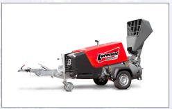
Technische Daten: - Druck-/Mischbehälter: 260 l mit Mittelabgang (200 l Nutzinhalt), - Förderentfernung: 180 m weit, 90 m hoch, - Fördermenge: 3,8-5 m³/h, - Förderdruck: 8 bar, - Kompressor: BOGE (Made in Germany) 4,4 m³/min, - Antrieb: 3-Zylinder DEUTZ Diesel mit Turboaufladung 36,4 kW (Abgasstufe STAGE V), - Tankinhalt: 70 l, - Befüllhöhe: 400 mm, - Straßenzulassung: bis 80 km/h, - Größtkorn: 16 mm, - Abmessung (LxBxH): 5020x1560x2515 mm, - Gewicht: 1840
