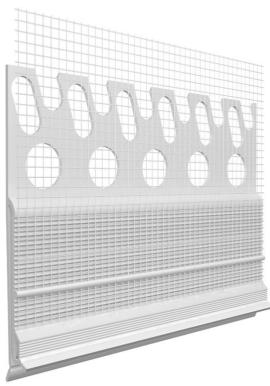
Das Anschlussprofil wird auf das Blech (zB Dachrandabschluss) bis zum Anschlagsteg aufgesteckt und justiert. Das Flächengewebe muss mindestens 10cm überlappen. Die einzelnen Profile werden mit den beiliegenden Steckverbindern verbunden. Das Armierungsgewebe und die Endbeschichtung sollen bis zur Tropfkante herangeführt werden.
