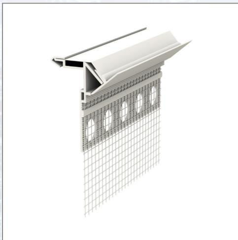
Kunststoffprofil mit Gewebe zum Anschluss an Attika-Abdeckungen bei WDV-Systemen. Aufgrund des entstehenden Windstaudrucks können durch Wasserhinterwanderungen Schäden am WDV-System eintreten, welche mit dem Attikaprofil verhindert werden können. Maximale Sicherheit gegen das Eindringen von Feuchtigkeit wird durch das integrierte Fugendichtband erzielt.
