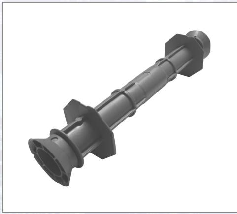
OKTAGON-PLUS ist ein PVC-freies einteiliges System zur Herstellung jeder Art von Schalungsspannstelle. Nach dem Entfernen der Schalung kann der Vorsatzkonus einfach herausgezogen werden. Zum Verschließen können die beiliegenden OKTAGON-Stopfen oder die optional erhältlichen OKTAGON-PLUS Sichtbetonstopfen bzw. Sichtbetonscheiben verwendet werden. Prüfzeugnis für Wasserdichtheit, Brandverhalten F180, Trinkwassereignung, Luftschalldämmung und aggressive Gewässer vorhanden.
