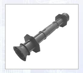
OKTAGON-PLUS ist ein PVC-freies einteiliges System zur Herstellung jeder Art von Schalungsspannstelle. Nach dem Entfernen der Schalung kann der Vorsatzkonus einfach herausgezogen werden. Zum Verschließen können die beiliegenden OKTAGON-Stopfen oder die optional erhältlichen OKTAGON-PLUS Sichtbetonstopfen bzw. Sichtbetonscheiben verwendet werden. Prüfzeugnis für Wasserdichtheit, Brandverhalten F180, Trinkwassereignung, Luftschalldämmung und aggressive Gewässer vorhanden.
