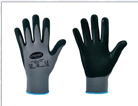
Nahtloser grauer Feinstrickhandschuh STRONGHAND® aus 92 % Polyamid (Nylon), 8 % Elasthan mit schwarzer Micro-Nitrilschaumbeschichtung und flachen Nitrilnuppen, gemäß EN 388 + EN 407. Hitzeschutz: Level 1 Kontakthitze gemäß EN 407. Hervorragende Passform, hoher Tragekomfort, sicherer Griff auch bei glatten Gegenständen, sehr gutes Tastempfinden, gute Beständigkeit gegen Öle und Fette (flüssigkeitsabweisend).
