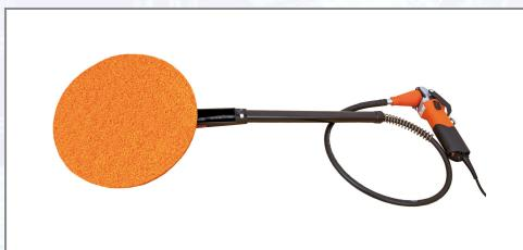
Zum Bearbeiten von Gipsputz, Kalk-Zementputz und Lehmputz. Die Spezialfilzmaschine ist für das Filzen von Putz, Rabottieren sowie Flügelglättungen von Wandputzen aller Art geeignet. Sie zeichnet sich durch ihr geringes Gewicht und stufenlose Drehzahlregelung aus. Technische Daten: - Leerlaufdrehzahl: 75-340 U/min, - Motorleistung: 230 V/1000 W, - Gewicht:
