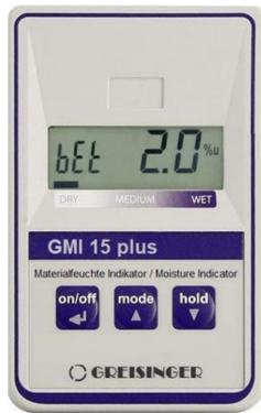
Für die Schnellbestimmung von Feuchtigkeit in Gebäuden oder am Bau. Kapazitiver Materialfeuchte-Indikator für zerstörungsfreie Messung. Anwendungen: Holz, Beton, Estrich, uvm. Messtiefe ca. 25 mm. Die Angabe 25 mm für die Eindringtiefe der Messung ist lediglich ein Anhaltswert. Das Gerät misst je tiefer, desto feuchter das Material ist. So wird bei sehr feuchtem Material auch tiefer als 25 mm gemessen.
