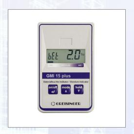
Für die Schnellbestimmung von Feuchtigkeit in Gebäuden oder am Bau. Kapazitiver Materialfeuchte-Indikator für zerstörungsfreie Messung. Anwendungen: Holz, Beton, Estrich, uvm. Messtiefe ca. 25 mm. Die Angabe 25 mm für die Eindringtiefe der Messung ist lediglich ein Anhaltswert. Das Gerät misst je tiefer, desto feuchter das Material ist. So wird bei sehr feuchtem Material auch tiefer als 25 mm gemessen.
