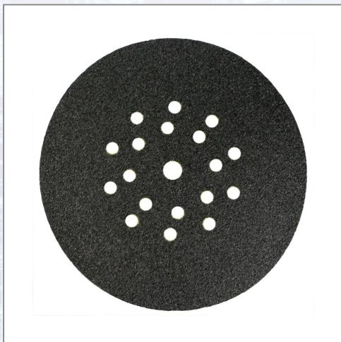
Geschmeidige Papierunterlage mit aufkaschiertem Velour für beste Anpassung an alle Schleifflächen, erhöhte Standzeiten durch optimierte Schleifkornstreuung und schleifstaubabweisende Stearatbeschichtung, Lochung für staubfreies Schleifen.
