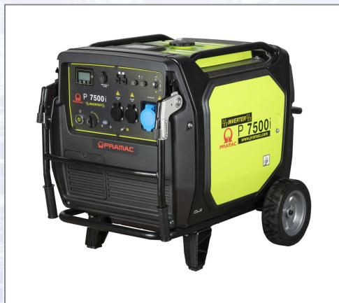
Mit POWERRUSH-Technologie für zusätzliche Anlaufstrom-Leistung. POWERRUSH erhöht die Leistung des Generators kurzfristig für schwer anlaufende Verbraucher. Technische Daten: - Spannung: 230 V, - Leistung Dauer/COP: 6500 W, - Leistung Max/LTP: 7000 W, - Motor: PRAMAC OHV, STAGE V, - Tankinhalt/Verbrauch: 25 l / 2,25 l/h bei 75 % Last = Laufzeit ca. 11,0 h, - Steckdosen: 2 x Schuko 230 V 16 A IP 44 und 1x 2P+T CEE 230 V 32 A IP 44, - Abmessungen: 950x765x773 mm, - Gewicht: 146 kg.
