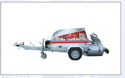
Standardausführung mit doppelten Deckel (1 Kammer), Gewicht: 1600 kg. Technische Daten: - Förderdruck: 8 bar, - Förderweite: bis 180 m, - Kompressor BMS: bis 4,5 m³/min, - Elektromotor 30 kW 63 A (frequenzgeregelt), - Befüllhöhe: 920 mm, - max. Korngröße: 16 mm, - Druckstutzen: VT 70. Im Lieferumfang enthalten: Silodeckel (1 Kammer), Doppelter Deckel für Mischkessel, Beleuchtungsbalken 12 V Österreich, Stecker 13-polig Kunststoff 12 V, Kugelkopfkupplung,
