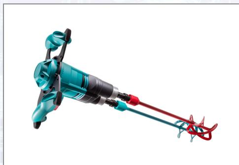
Kompaktes Modell für intensives und schnelles Mischen durch gegenläufige Mischwerkzeuge. Hohes Leistungsvermögen und vielfältige Einsatzmöglichkeiten. Leicht im Material zu führen, da kein Gegendrehmoment über die Rührer auf den Bediener wirkt. Top-Ergonomie durch aufrechte Arbeitsposition, optimale Griffanordnung. Mit Schnellwechselkupplung HEXAFIX®, für viele Materialien geeignet (Mörtel, Estrich, Beton, quarzgefüllte Epoxydharze, Putz, Spachtel, uvm.). Made in Germany.
