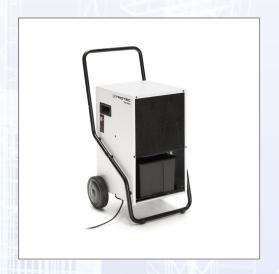
Technische Daten: - Leistung (30 °C/80 %): 55 l/24 h, - Leistung max.: 70 l/24 h, - Luftmenge: 490 m³/h, - Arbeitsbereich/Temperatur: +5 bis + 32 °C, - Arbeitsbereich/Luftfeuchtigkeit: 50-90 %, - Anschlussspannung: 230 V/50 Hz, - Leistungsaufnahme max.: 1,4 kW, - Kältemittel: R-454C, - Kältemittelmenge: 650 g, - CO2-Äquivalent: 0,0949 t, - Wasserbehälter: 6 l, - nicht färbende Vollgummireifen, - Abmessung (LxBxH): 530x500x965 mm, - Gewicht: 39 kg.
