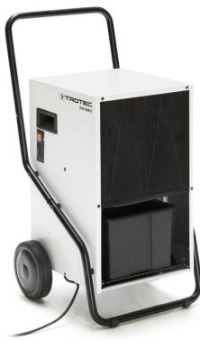
Technische Daten: - Leistung (30 °C/80 %): 55 l/24 h, - Leistung max.: 70 l/24 h, - Luftmenge: 490 m<sup>3</sup>/h, - Arbeitsbereich/Temperatur: +5 bis + 32 °C, - Arbeitsbereich/Luftfeuchtigkeit: 50-90 %, - Anschlussspannung: 230 V/50 Hz, - Leistungsaufnahme max.: 1,4 kW, - Kältemittel: R-454C, - Kältemittelmenge: 650 g, - CO<sub>2</sub>-Äquivalent: 0,0949 t, - Wasserbehälter: 6 l, - nicht färbende Vollgummireifen, - Abmessung (LxBxH): 530x500x965 mm, - Gewicht: 39 kg.
