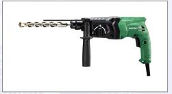
SDS-Plus-Kombihammer zum Hammerbohren (Beton, Stein, Ziegel), Bohren (Holz, Metall) und Meißeln (leichte Stemmarbeiten). Die Steuerelektronik sorgt für eine stufenlose Dreh- und Schlagzahlvorwahl über Schalter. Der Kombihammer ist mit einer Sicherheitsrutschkupplung, optimal positionierter Rechts-/Linkslauf-Umschalter sowie mit Abschaltkohlebürsten ausgestattet. Technische Daten: - bei Volllast: 0 - 3950 /min, -
