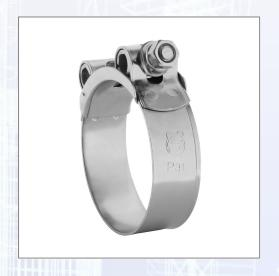
Eine widerstandsfähige Klemme, die Dichtheit bei hohen Drücken garantiert. Das Schraubsystem basiert auf einer hochfesten Sechskantmutter, die ein einfaches Anziehen mit jedem Werkzeugtyp ermöglicht. Ihre abgeschrägten Kanten verhindern Einschnitte in Rohren und Kunststoffen. Material: verzinkter
