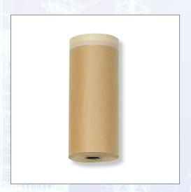
Zum Abkleben und Schützen von glatten und leicht rauen Untergründen im Innenbereich. Bis 7 Tage einsetzbar und rückstandfrei entfernbar. Für kleinere Flächen wie Fuß- und Sockelleisten, Türrahmen usw. Spezifikation Kreppband: - Dicke: ca. 0,13 mm, - Kleber: Naturkautschuk, - Klebekraft: ca. 6 N/25 mm, - Hitzebeständigkeit: 60 °C kurzfristig. Spezifikation Papier: Material: - Natron-Kraftpapier, - Gewicht: 35 gr/m². !Keine Haftung für Rückstände!
