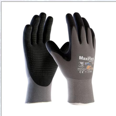
Montagehandschuh mit Anti-Transpirant-Technologie (aktive Kühlung) AD-APT® und beschichtete Handinnenfläche gemäß EN 388, 15 Gauge Nylon-Gewirk, passgenauer Sitz durch anatomisches Design, aufgesetzte Nitrilnuppen für bessere Griffsicherheit und längere Standzeiten, Strickbund. Für Arbeiten in trockenem Umfeld, Werkzeugen und Leitungen, Automobilindustrie, Mikrotechnik sowie Werkstätten und Montage.
